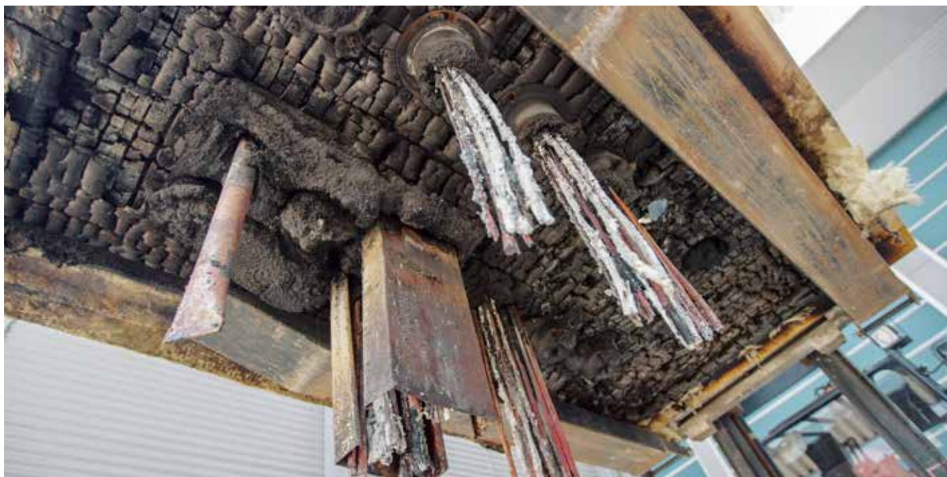
Brettsperrholz-Prüfkörper nach einer Feuerwiderstandsprüfung nach EN1366-3
