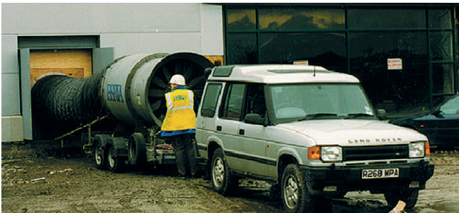
„Blower door test“
