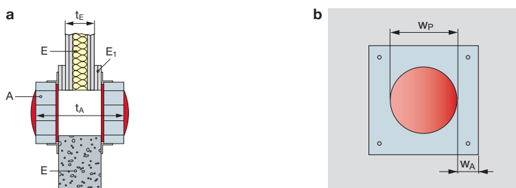
Abb. 2: Rahmung und Aufleistung der Abschottung in Wänden/Decken.
