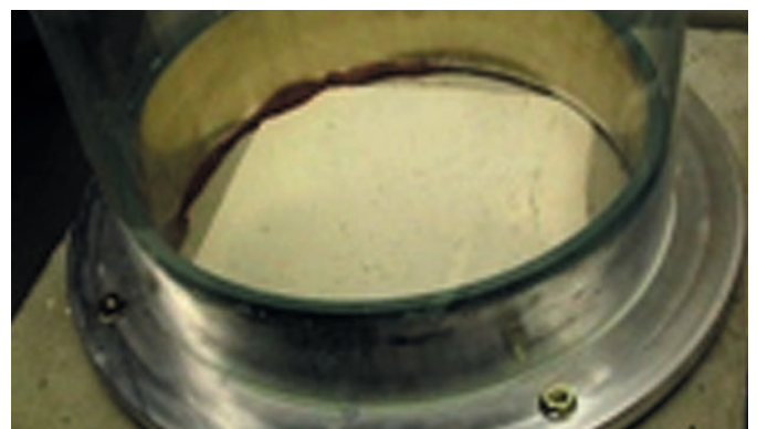
CFS-S SIL mit Flansch und Plexiglasrohr montiert.
