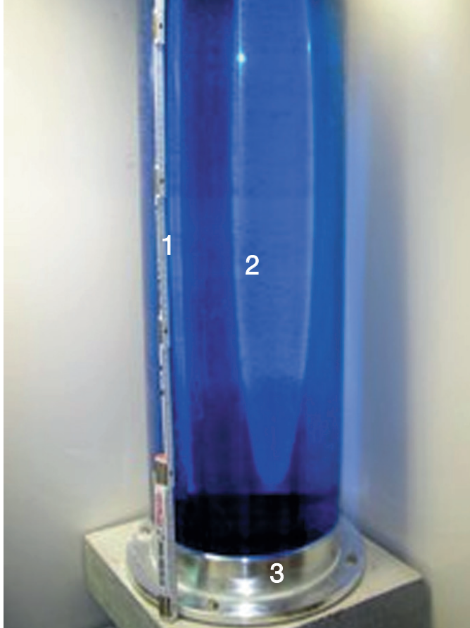
Bildbeschreibung 1) 1 m Wassersäule 2) Wasser (gefärbt) 3) Probekörper
